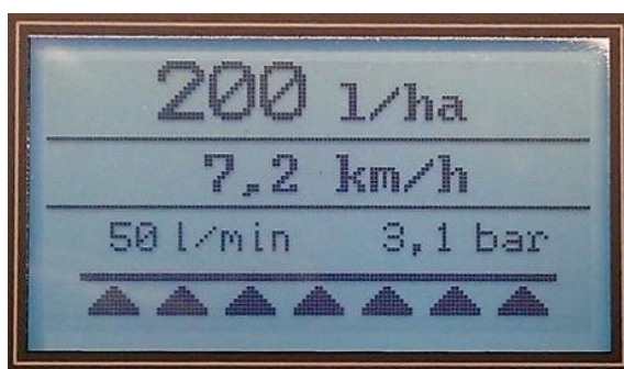
Główne okno widoczne po załączeniu sterownika
